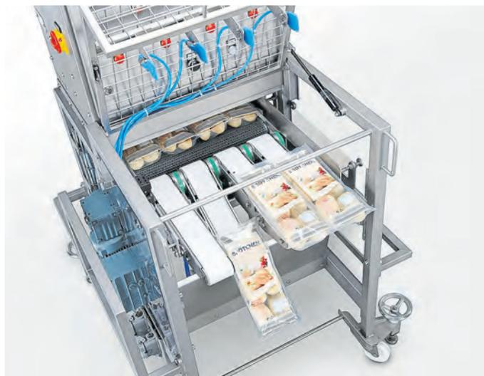
Die Qualitätsprüfung erfolgt durch Pneumatikzylinder, die auf die Vakuumverpackung drücken. Gibt diese nach, bedeutet dies, dass Luft entweicht. Die undichte Verpackung wird ausgeschleust.
