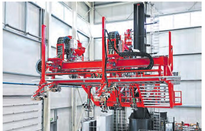
**King Kong heißt dieser Schweißroboter der Firma HAANE Welding Systems, der beim Bau von Offshore-Windanlagen zum Einsatz kommt.**
